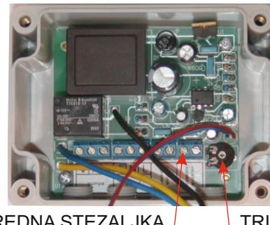
Diferencijalni termostat tvrtke Centrometal namijenjen je ugradnji u solarne sustave i sustave centralnog grijanja gdje je potrebno uključivati tj. isključivati pumpu prema zadanoj (namještenoj) razlici temperatura.
